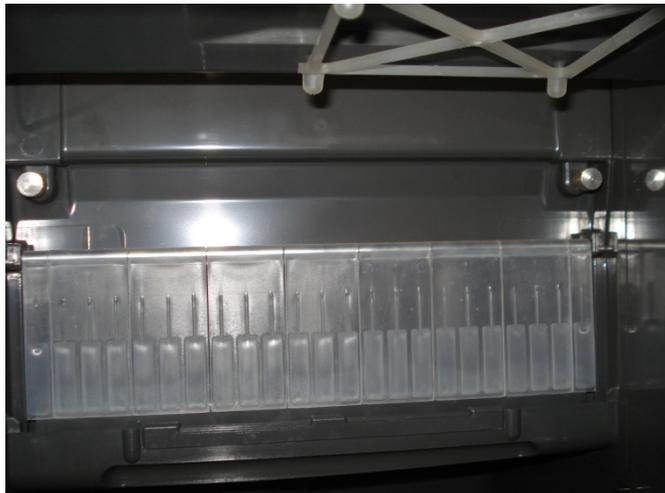
1- Remova os parafusos e retire a cortina do reservatório.
