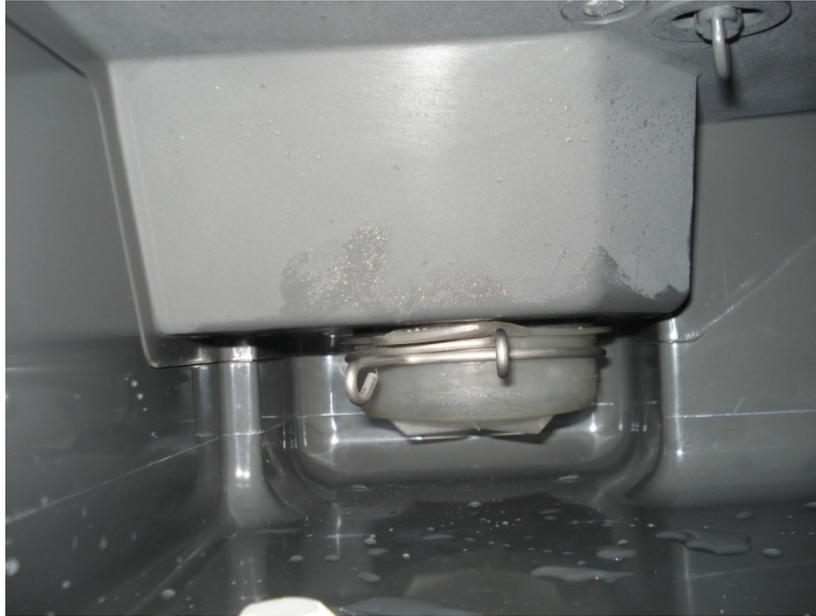
5 - Para retirar o excesso de água com solução anti-calcárea. Retire a abraçadeira e o tampão do fundo do reservatório de água e drene para o bin.
