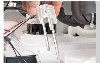
Sensor de água baseado na condutividade elétrica
